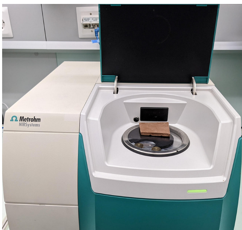
Figure 1. メトローム社製DS2500 Solidアナライザーとチョコレートバー
