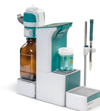
Figure 1. Titulador profissional OMNIS equipado com um dUnitrode com Pt1000 integrado.
