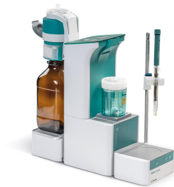
Hình 1. Máy chuẩn độ OMNIS Professional được trang bị điện cực dUnitrode tích hợp đầu dò nhiệt Pt1000.
