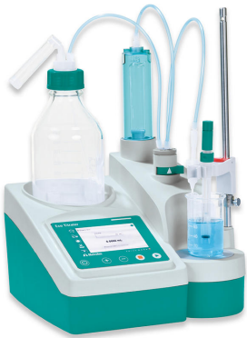
Hình 1. Eco Titrator được trang bị điện cực EtOH-Trode giúp điều chỉnh giá trị pH nhanh chóng
