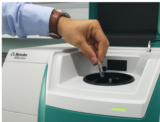
Hình 1. Máy phân tích chất lỏng DS2500 và mẫu được đựng trong vial dùng một lần.
