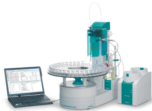
Figure 1. 全自动系统由 874 Oven Sample Processor 和 851 Titrand 组成，用于在样品中存在的任何水分蒸发后进行库仑卡尔费休。
