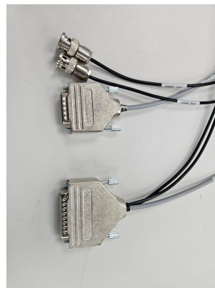
图4. 本系统中使用的 DIO 触发线与 BNC 电缆
