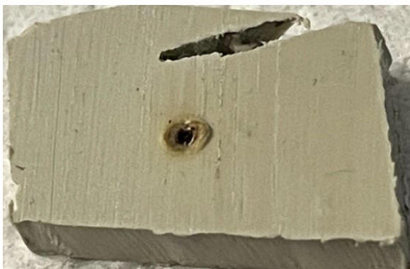
图 5. 使用1064nm系统燃烧样品的示例。该材料经MIRA XTR DS鉴定为聚苯醚（PPE）。
