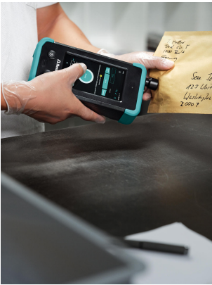
图1. 安全部门需要在邮件中快速确认从芬太尼到炭疽杆菌等违禁品，这是一个棘手的问题。拉曼光谱能够穿透纸张进行扫描的能力是一个强大的优势。
